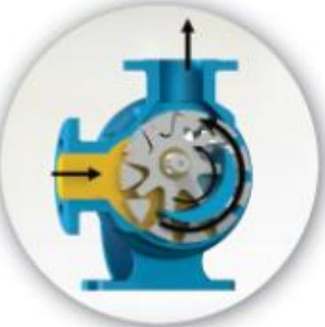
"Dişli içinde dişli" prensibinde çalışan dişliler ile pompa içinde sıvının ilerleyişine dikkat edin. Aynı zamanda, pompa kapağı üzerindeki hilal şeklinin sıvayı nasıl böldüğüne ve emiş ile boşaltma ağızları arasında bir keçe (conta) gibi vazife gördüğünne dikkat ediniz.
