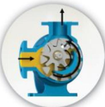
Bu resim pompanın iç kısmının dolup sıvının boşaltma ağızı alanına itilmesinden hemen önceki durumunu göstermektedir. Avare ve rotor dişlilerinin dizaynının sıvı için nasıl bir kapalı cep oluşturduğuna ve bunun tam bir hacim kontrolü sağlanması nasıl garantilediğine dikkat ediniz.
