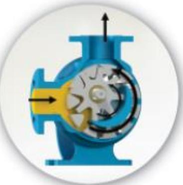
Yandaki renkli kısım sıvının pompa gövdesindeki emiş ağızı alanına, rotor dişlisi ve avare dişlisi dişleri arasındaki dişli boşlukları alanına girişini gösterir. İki siyah ok pompanın dönüş ve sıvının ilerleyişini gösterir.
